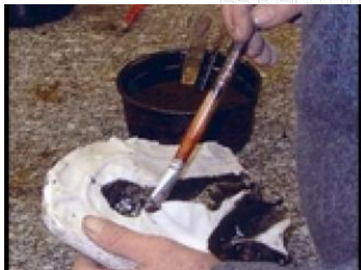
Du plâtre à l'épreuve de cire. ©CLICHÉ MUSÉE - JARDIN BOURDELLE - CAI FONDEUR
